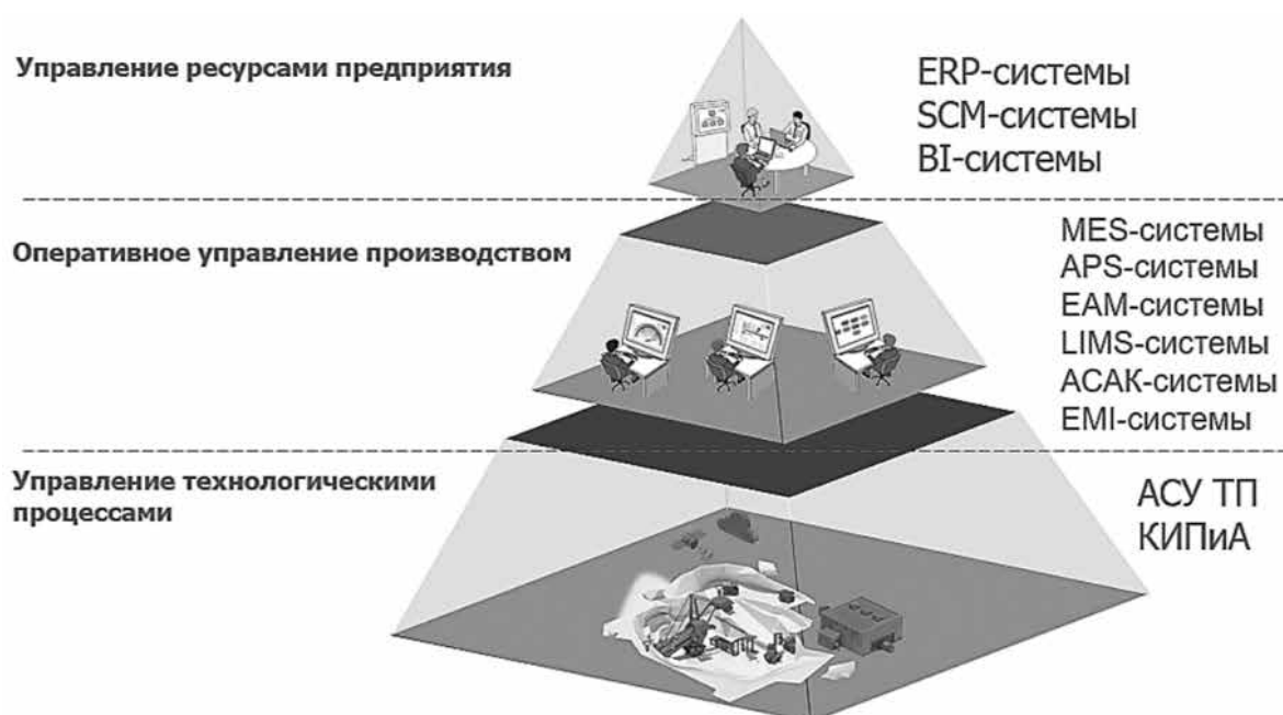
Рис. 2. Иерархия цифровых систем на разных подуровнях управления горным производством
