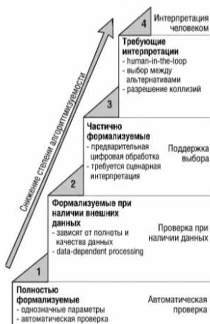
Рис. 2. Группы проектных требований по степени алгоритмизируемости
