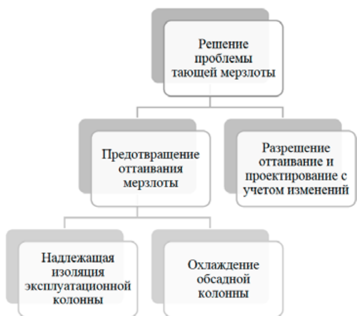
Рис. 1. Способы решения проблемы таяния мерзлоты при нефтедобыче
